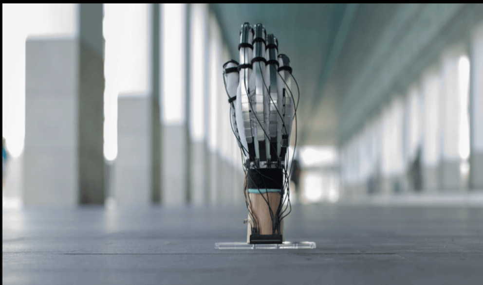
МОДЕЛ НА СВРЪХЛЕКА ХАПТИЧНА РЪКАВИЦА – С ДЕБЕЛИНА НА МАТЕРИЯТА 2 мм И ТЕХНИКА, ТЕЖАЩА 8 гр.
